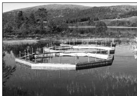
En ombygd flåte for kommersielle laksemærere ble benyttet i innhegningsforsøkene.
